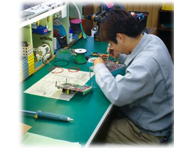
←チップ部品は変換シートを使って組配した例です。
